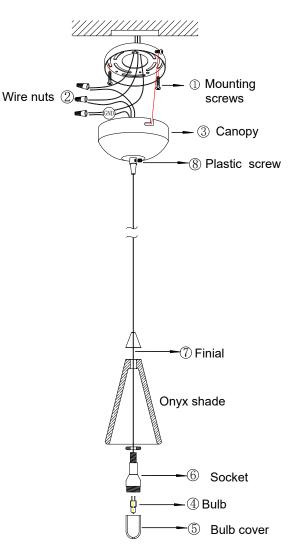
PLEASE ENSURE "NEVER INSTALL THE FIXTURE TO THE WALL OUTLET BOX, WHICH CAN'T BE COVERED BY THECANOPY"
